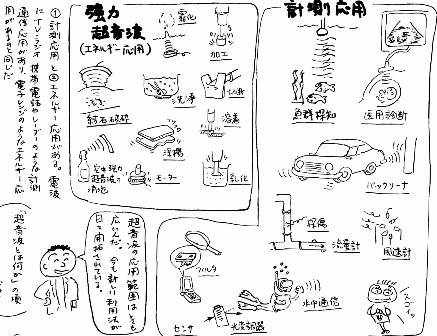
実際の超音波応用では、20 kHz 以下も使われている。また、空気・水中だけでなく、金属などの振動も超音波の工業応用でよく利用される。それで、「聴くことを目的とした音」を超音波の定義とすることもある。
